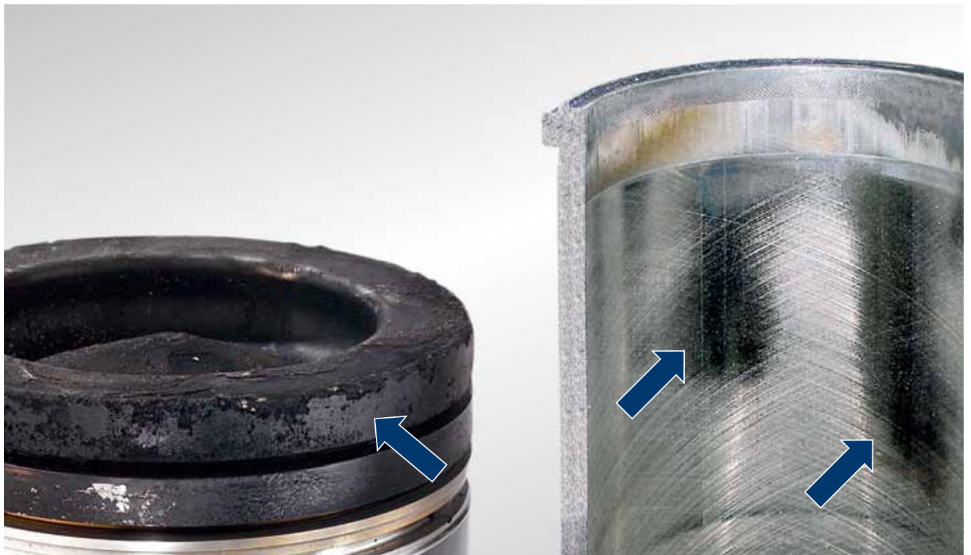
Fig. 4: Capa de aceite carbonizado en el segmento de fuego y desgaste abrasivo en la superficie de rodadura del cilindro
